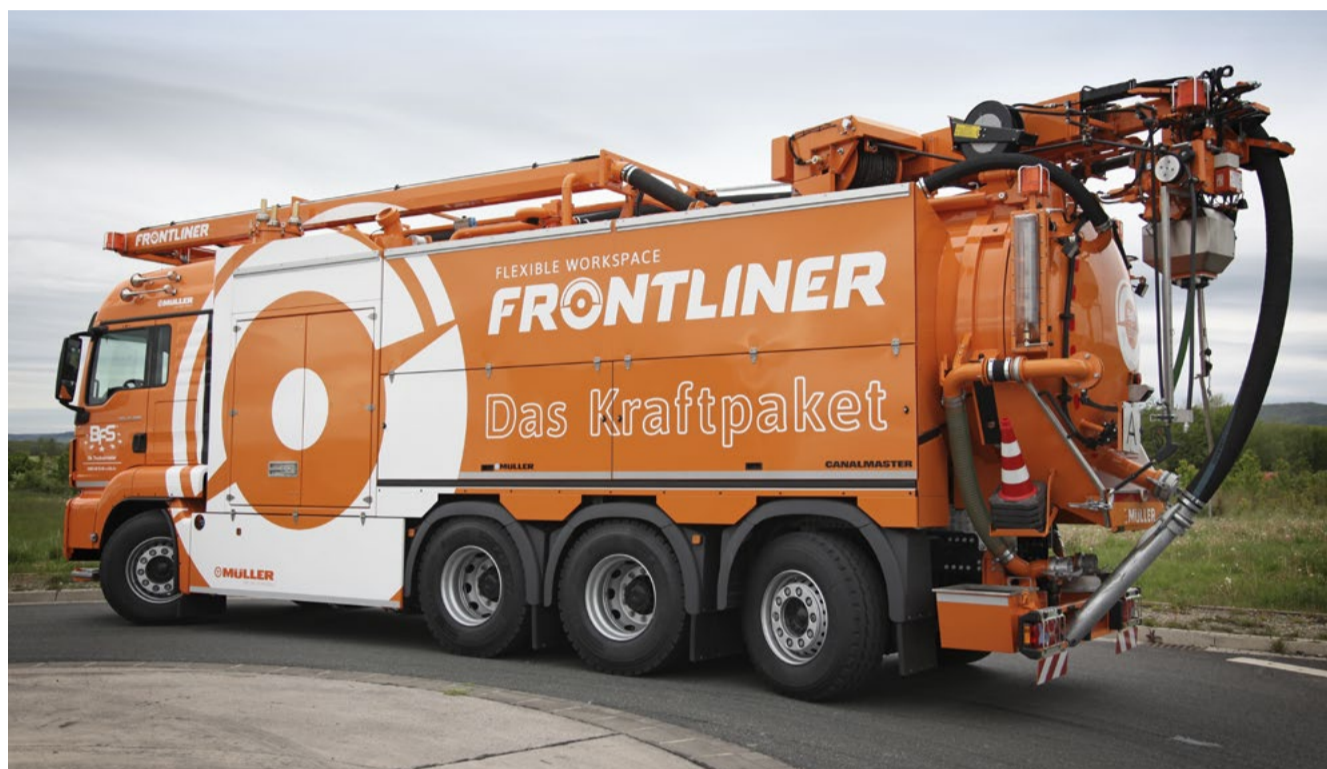
Der Saugspüler von BFS ist ein vielseitig einsetzbares Fahrzeug zur Wartung und Reinigung von Kanälen.
