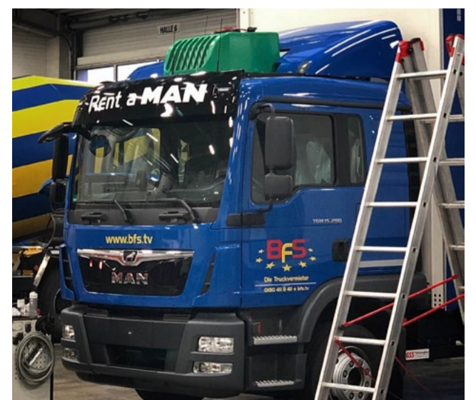
Das BFS-Fahrzeug wurde in der Werkstatt von BFS-Partner Stegmaier Nutzfahrzeuge mit dem Partikelfilter von Mann+Hummel ausgerüstet.
